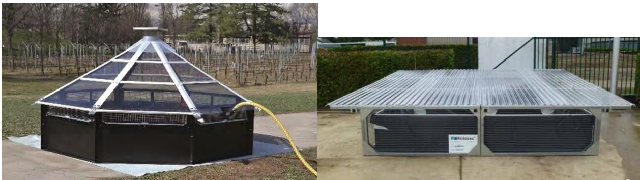
Figuur 27. Afvalverwijdering op basis van verdamping (links: bron RemDry®, 2024, rechts: bron: Heliosec® BES)
